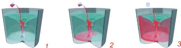
Si consiglia il suo montaggio decentrato per minimizzare il vortice e evitare l'installazione di rompitorrente.
